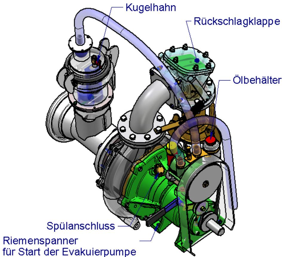
Die **Kreiselpumpe** kann das Medium (Wasser bzw. Gülle) nicht selbsttätig ansaugen - das übernimmt die Selbstsaugereinrichtung.
