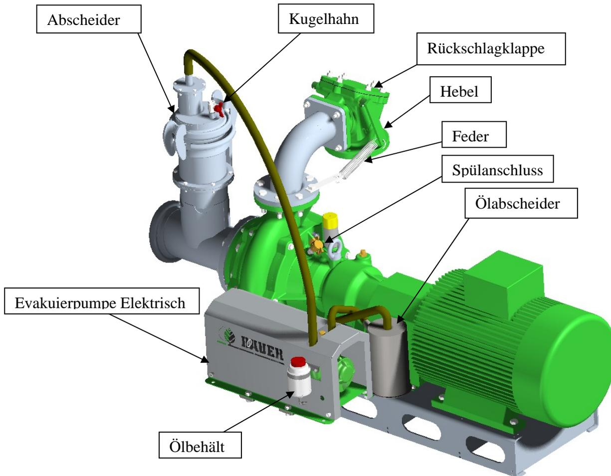
Die **Kreiselpumpe** kann das Medium (Wasser bzw. Gülle) nicht selbsttätig ansaugen - das übernimmt die Selbstsauginrichtung.
